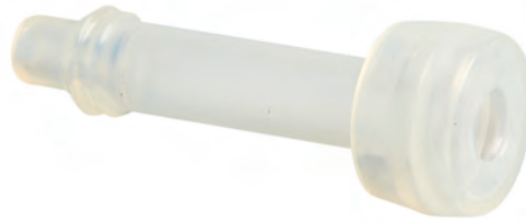
20073955 SILICONE LINER FOR SHEEP FITTING: FULLWOOD, INTERPULS, L'ITALIANA, MILKLINE, SPAGGIARI MOUTH: Ø 18.5 - EXIT: Ø 10 LENGTH: 139 Guaina silicone pecore Adattabile: FULLWOOD, INTERPULS, L'ITALIANA, MILKLINE, SPAGGIARI Bocca: ø 18.5 - Uscita: ø 10 - Lungh.: 139
